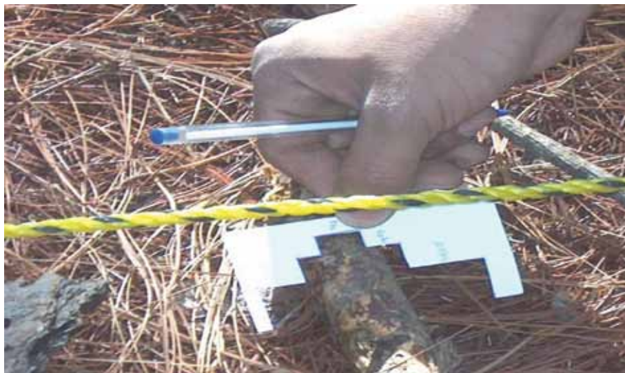
Figura 4. Uso del calibrador para la medición de los combustibles de acuerdo a su tiempo de retardo. Figure 4. Caliper use for the measurement of fuels according to their retardation time.
