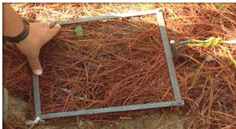
Figura 5. Cuadro de 30 x 30 cm para la toma de muestras de combustibles finos. Figure 5. 30 x 30 cm square to take fine fuel samples.
