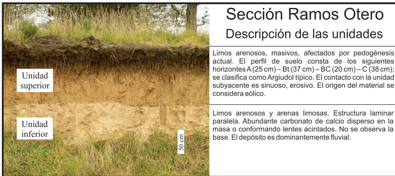
Figura 2 Fotografía de la sección estratigráfica analizada y descripción de las unidades.
