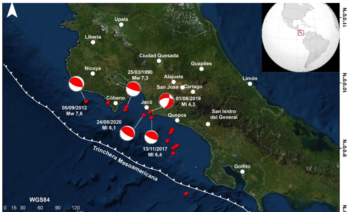
Figura 4 Se muestran con círculos rojos los epicentros para sismos que se han registrado en el Pacífico Central de Costa Rica, desde 1984 hasta agosto de 2020, con magnitudes MI > 5.9. Se destacan cuatro principales eventos con su respectiva fecha y magnitud asociada a) el sismo del 25 de marzo de 1990 (Mw 7.3), b) el sismo del 05 de septiembre de 2012 (Mw 7.6), conocido como el terremoto de Nicoya, c) el sismo del 13 de noviembre de 2017 (MI 6.4) y d) el sismo del 01 de junio de 2019 (MI 4.3), e) el sismo del 25 de agosto de 2020 (MI 6,1). Los MF para el sismo del 05 de septiembre 2012 (Quintero et al. , 2014) y para el sismo de 25 de marzo 1990 (GCMT, 2020); los otros tres se realizaron en este trabajo. Los MF indican que los sismos ocurren como consecuencia de fallas inversas asociadas a la subducción de la placa de Cocos bajo la placa Caribe, buzando al nor-noreste y en bajo ángulo.
