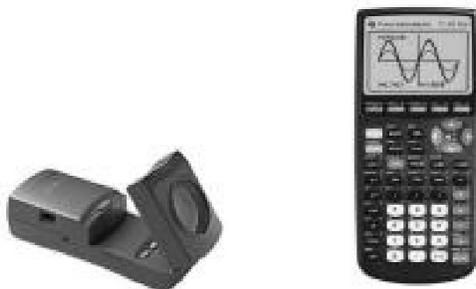
**Figura 1** El Calculator Based Ranger® (a la izquierda) es un artefacto concebido para estudiar los objetos en movimiento: a través de la emisión de ondas, el CBR recoge datos de su distancia al objeto en cuestión. Al conectarse a una calculadora gráfica (por ejemplo, TI-83+®, mostrada a la derecha), es posible obtener gráficas espacio-tiempo, velocidad-tiempo, etcétera
