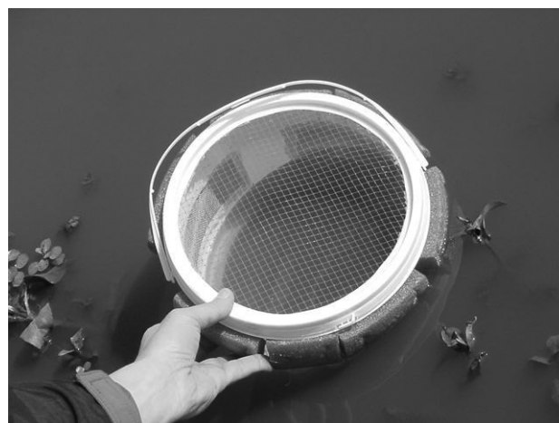
Figura 1. Limnocoral utilizado en la exposición de Lemna gibba L. al Roundup®Max a campo. La tapa, el fondo y las ventanas del limnocoral son de malla plástica, permitiendo la circulación del agua a través del mismo. El dispositivo posee flotadores, para ajustarse a las variaciones de nivel de la columna de agua.
