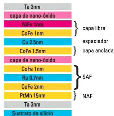
Figura 13. a) Materiales magnéticos utilizados en la fabricación de las cabezas de lectura/escritura. b) Sustratos que componen la cabeza de lectura – escritura
