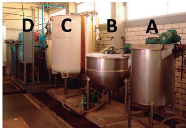
Foto 1. Plata piloto de producción de alginatos, A) tanque de hidratación y pre-extracción, B) marmita de extracción, C) tanque de dilución, D) filtro rotatorio al vacío marca Alar
