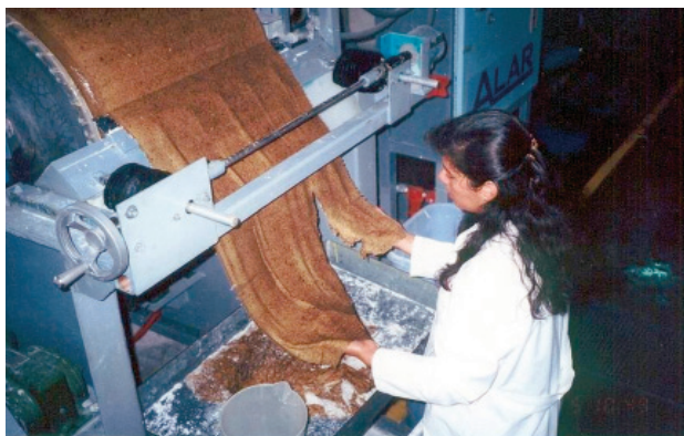
Foto 2. Filtro rotatorio al vacío empleado para la clarificación de la solución de alginato. Se observa el tambor giratorio y la capa de partículas de algas que se pegan a la cama de tierras de diatomeas por el efecto del vacío
