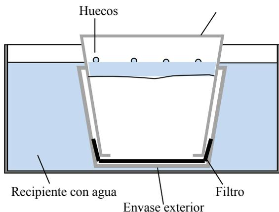
Figura 6. Gráfico del ensayo de absorción modificado
