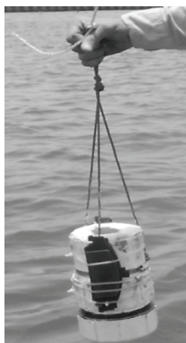
Figura 5. El tranceptor submarino con pesos sujetos a la carcasa mediante cinchos a fin de hundirlo en el agua y realizar pruebas de campo. El tranceptor de rastreo tiene la misma forma
