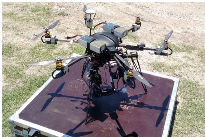
Figure 1. The unmanned aerial vehicle (UAV) Hexacopter and Sony NEX-7 camera. Figura 1. Vehículo aéreo no tripulado (UAV) hexacóptero y cámara Sony NEX-7.
