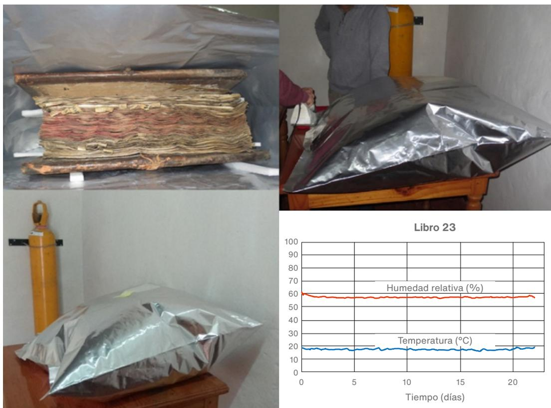
FIGURA 4. Tratamiento anóxico del Libro 23: sellado térmico en bolsa llena de nitrógeno, monitoreo de humedad y temperatura durante el tratamiento (Fotografías: Javier Nakamatsu, Jhonatan Arízaga, Ivon Canseco y Patricia Gonzales; cortesía: Museo del Convento de los Descalzos).
