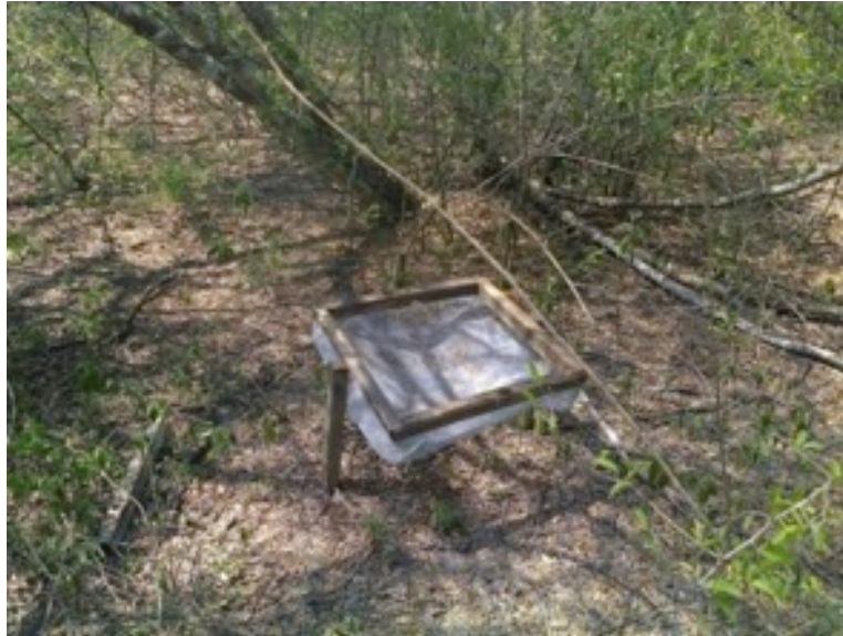
Figura 3. Canasta de malla utilizada para la captación de hojarasca en el sitio de MET (octubre de 2011).
