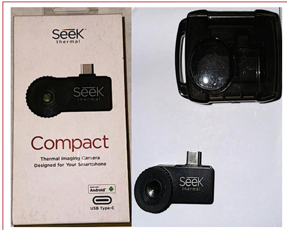
Figura 1. Cámara Seek Thermal. Cámara de termografía compacta con sensor térmico de 206 x 156 de uso móvil con entrada tipo C. Rango de temperatura de detección -40 a 330 °C.
