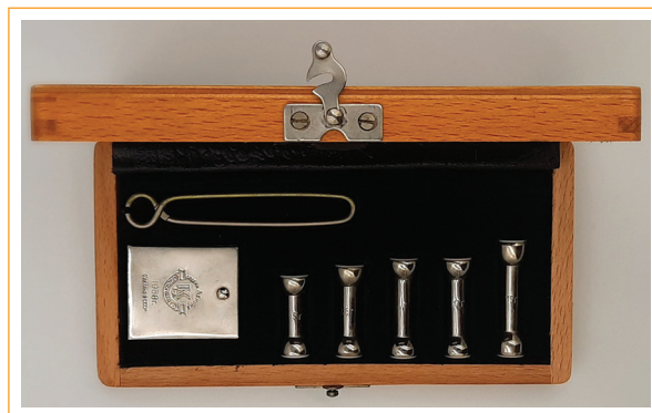
Figura 1. Tonómetro en su caja de madera fabricado en 1950 por PJSC Krasnogvardeets.
