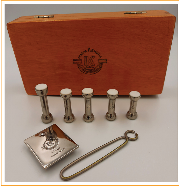
Figura 2. Se aprecian los diferentes pesos del tonómetro ordenados, la pinza de sujeción y el reservorio de tinta.
