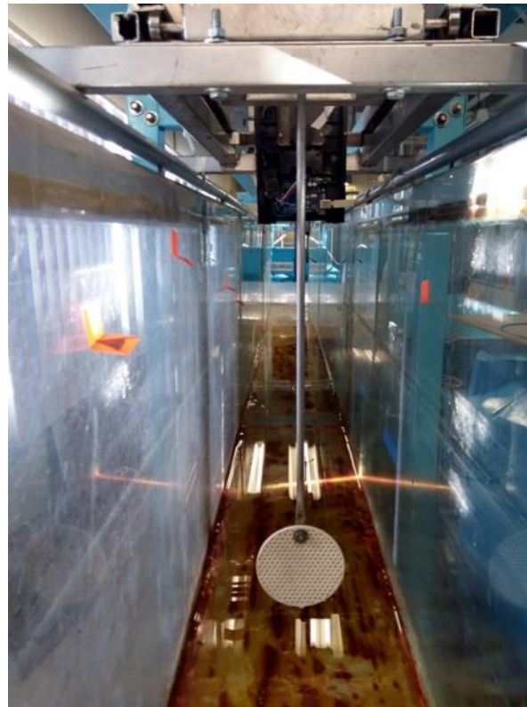
Figura 8. Dispositivo para medir el empuje hidrodinámico sobre un disco poroso.
