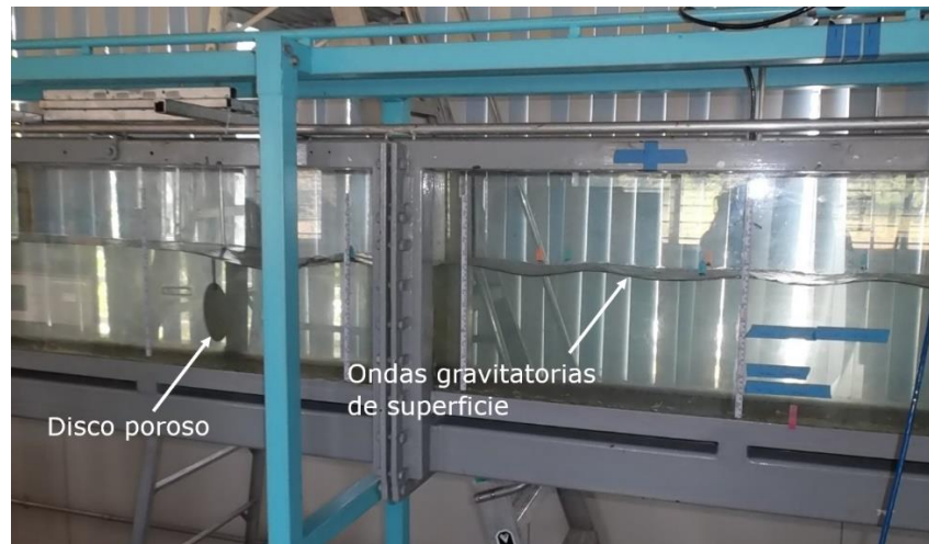
Figura 6. Ondas gravitatorias de superficie utilizando un disco poroso D_3 = 135.7 mm.
