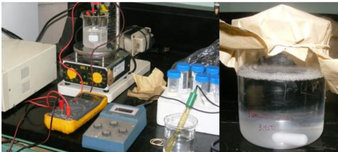
Figura 5. Izquierda: sistema electroquímico utilizado para la electrocoagulación de soluciones inoculadas con bacterias; derecha: solución electrocoagulada luego de un reposo de 24 horas.
