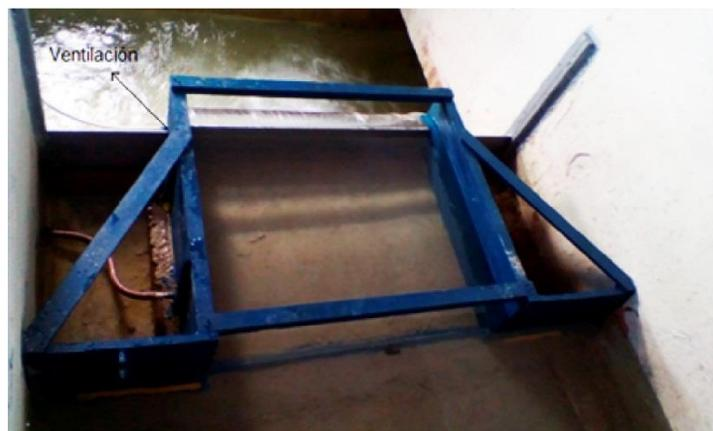
**Figura 3.** Vertedor rectangular de caída libre y sin contracciones laterales. Fuente: Borroto-Roche (2018).
